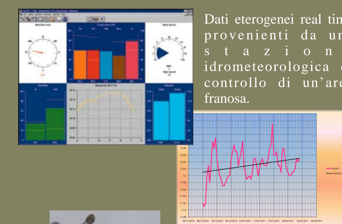
Diagramma di spostamento di ammassi rocciosi rilevato da un data logger collegato ad un misuratore di giunti.
