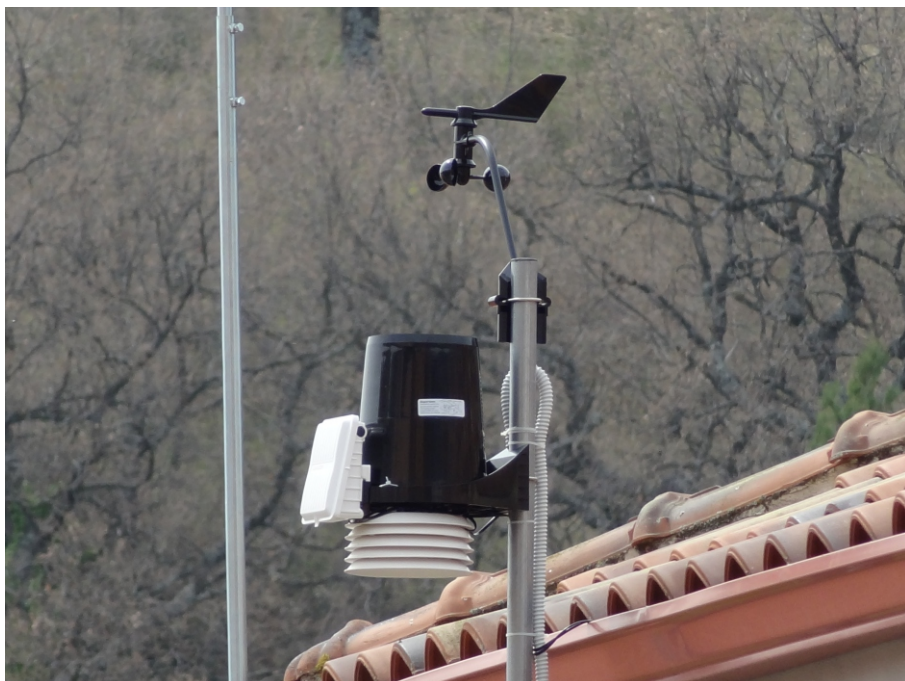
Comune di Gorgoglione - Modulo di controllo termopluviometrico, real time ed h24
