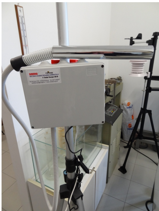
Modulo di controllo ed allarme real time e da remoto del livello delle acque nei fiumi e nei bacini e dell'umidità del suolo
