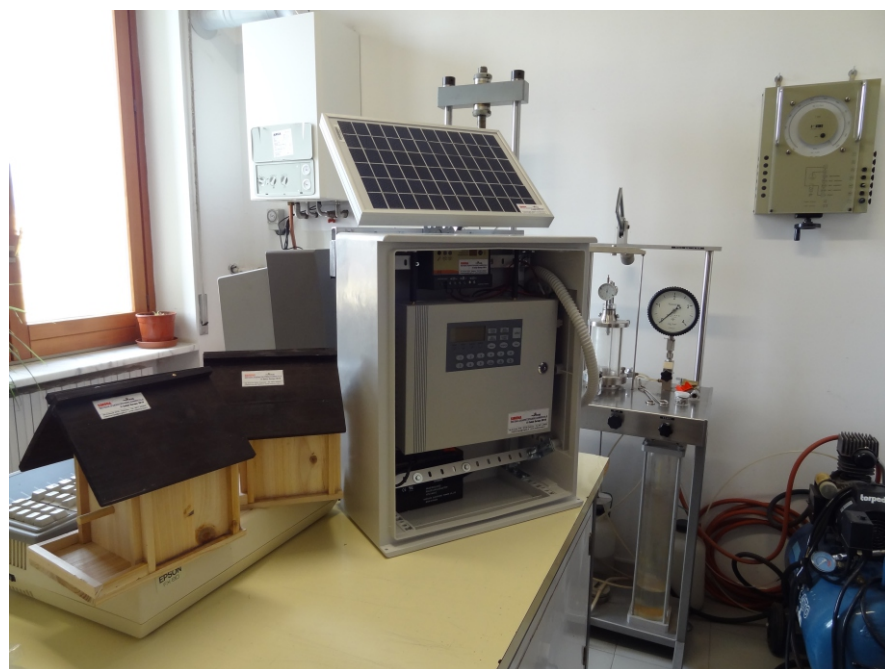
Modulo di ricezione ed invio dati numerici ed allarmi di focolai di incendio, livelli idrici, umidità del suolo, spostamenti di masse, etc. Al lato sensori ecologici per l'intercettazione di focolai di incendio
