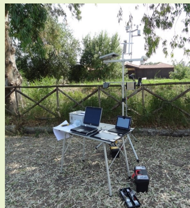
Piattaforma montabile su automezzo con sensori di monitoraggio e mobile gis
